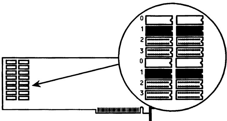
Wenn Sie das Einsetzen der Chips beendet haben, können Sie den Graphics Controller in Ihren Computer einbauen. *Es gibt keine Konfigurationsschalter, welche eingestellt werden müssen.*
