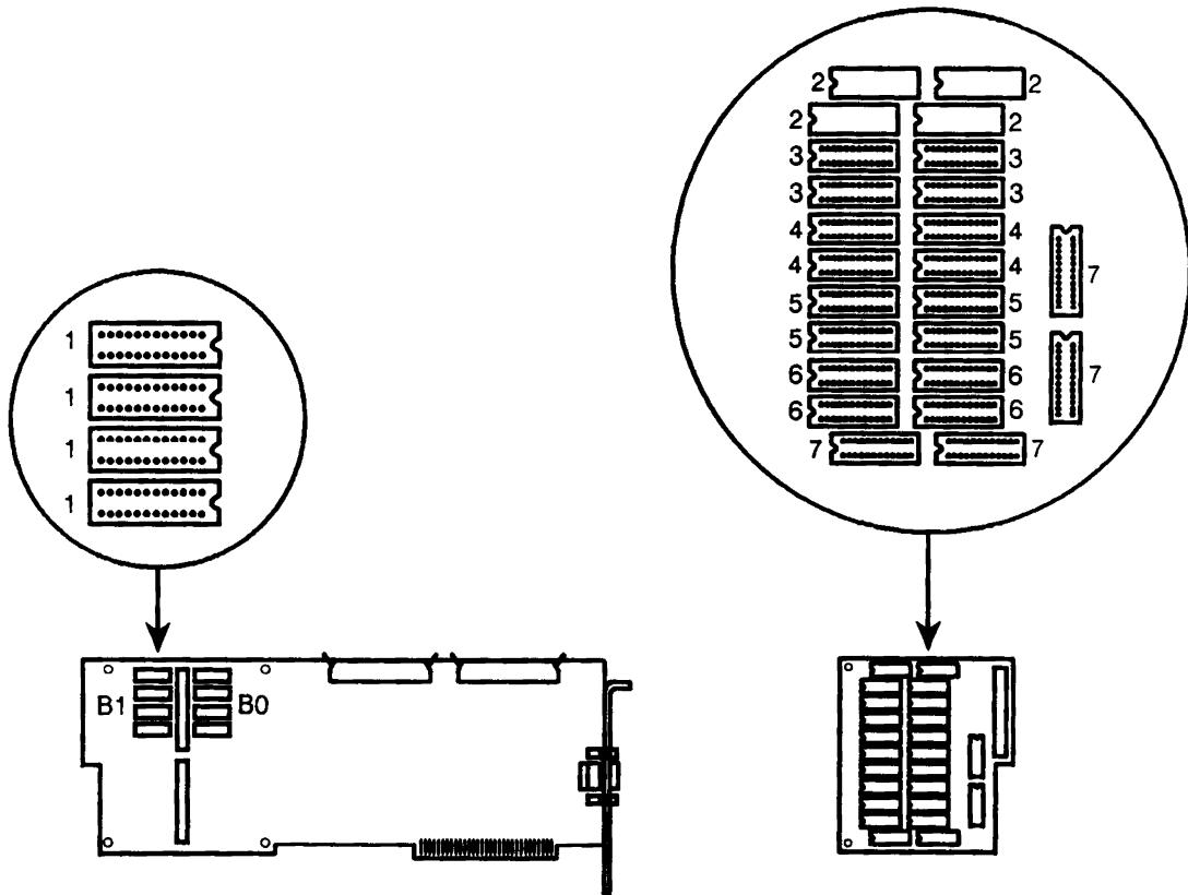
Der RAM Erweiterungssatz HP 82303 enthält einen 512 KByte Block (4 Chips) mit RAM. Sie können bis zu 5 dieser RAM Sätze auf einer RAM Erweiterungskarte HP 82305 installieren. (Beziehen Sie sich auf die vorangehende Abbildung zum Auffinden der RAM Blöcke.) Sie müssen allerdings folgendes beachten:
