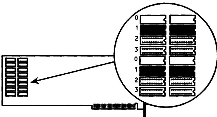
Quando avete finito di installare i CI, potete inserire il controller grafico nel vostro computer. *Non ci sono commutatori di configurazione da predisporre.*
