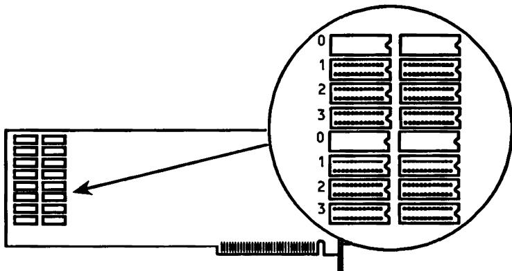
Der RAM Erweiterungssatz HP 82303 enthält einen 512 KByte Block (4 Chips) mit RAM. Sie können bis zu 3 dieser RAM Sätze im Graphics Controller installieren. Die Vorgehensweise zum Installieren der RAM Chips ist ähnlich zu der Installation auf dem Language Processor, außer daß alle Chips auf dem Graphics Controller installiert werden; es ist keine Erweiterungskarte erforderlich. Außerdem gibt es keine RAM Konfigurationschalter auf dem Graphics Controller (die Konfiguration erfolgt automatisch).
