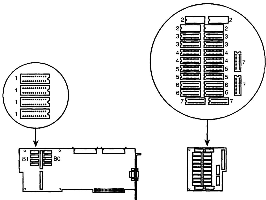
HP 82303 RAM拡張キットには512KバイトのRAMブロックが1ブロック（4個のIC）分入っています。HP 82305 RAM拡張ボードには、このRAMキットを最大5個組まで取り付けることができます（各RAMブロックの位置については、先の図を参照してください）。なお、拡張メモリを正しく機能させるには、以下の規定に従ってください。
