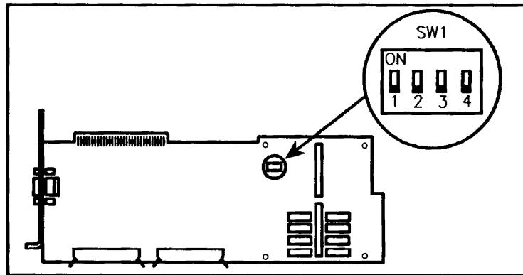
どのRAMブロックを取り付けたかを確認（RAM拡張ボード上のRAMも入れます）してください。SW1を下表のようにセットしてください。
