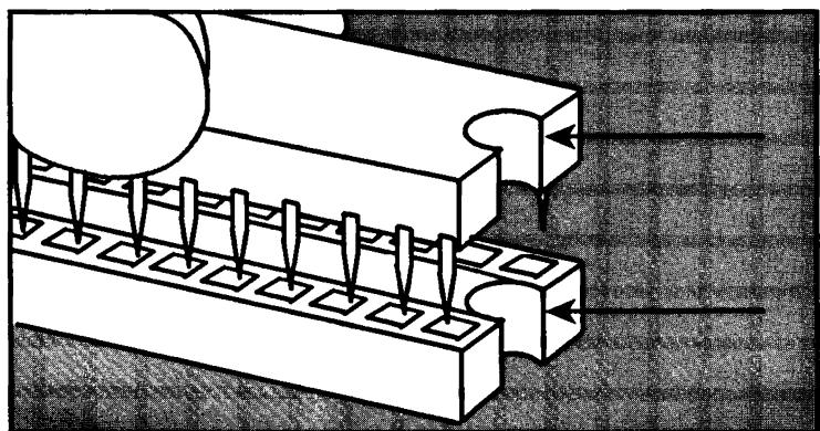
6. Alignez les broches du circuit avec les trous du connecteur. Lorsqu'ils sont bien alignés, appuyez sur le circuit jusqu'à ce qu'il soit bien inséré. Si une ou plusieurs broches ne sont pas bien insérées, retirez le circuit et répétez la procédure.
