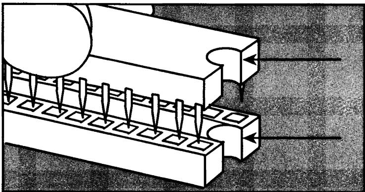
6. Alinee todas las patillas del CI con los agujeros del receptáculo. Una vez alineado, presione hacia abajo el CI hasta que quede completamente insertado. Si alguna de las patillas no quedara insertada debidamente, retire el CI y repita este paso.
