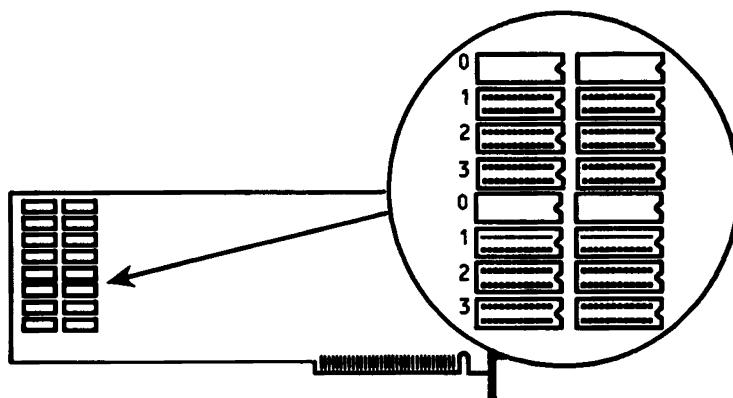
HP 82303 RAM拡張キットには512KバイトのRAMブロック（4個のIC）1ブロック入っています。グラフィックス・コントローラ上には、このRAMキットを計3個まで取り付けることができます。RAM ICをグラフィックス・コントローラに取り付ける手順は基本的に、82321 言語プロセッサの場合と同じです。ただし、ICはすべてグラフィックス・コントローラ上に取り付ける点だけが異なります。RAM拡張ボードは必要ありません。また、グラフィックス・コントローラ上には、RAM容量スイッチは付いていません（設定済みです）。
