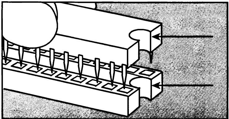
6. Richten Sie alle Anschlußstifte des Chips mit den Steckkontakte des Sockels aus. Wenn alles übereinstimmt, drücken Sie den Chip fest in den Sockel, bis sich die Unterkante des Chips mit der Oberkante des Sockels deckt. Sitzt ein Anschlußstift nicht korrekt, ziehen Sie den Chip wieder vom Sockel ab und wiederholen Sie diesen Schritt.
