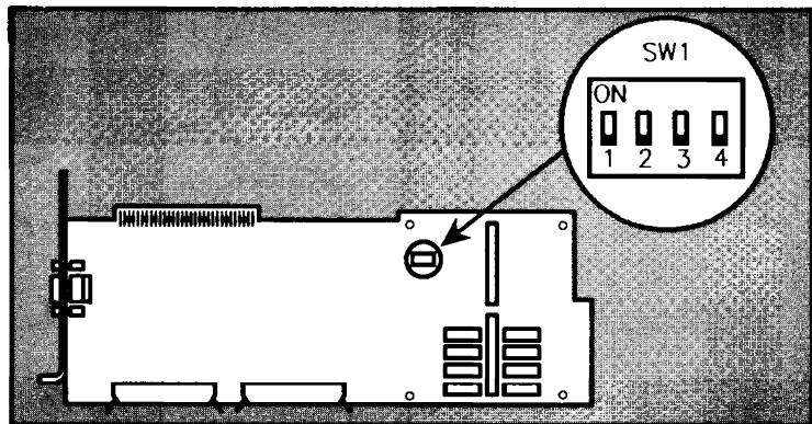
Determine cuáles son los bloques de RAM que están instalados (incluyendo la RAM de la tarjeta de ampliación). Fije los conmutadores de SW1 tal como se muestra en la siguiente tabla.
