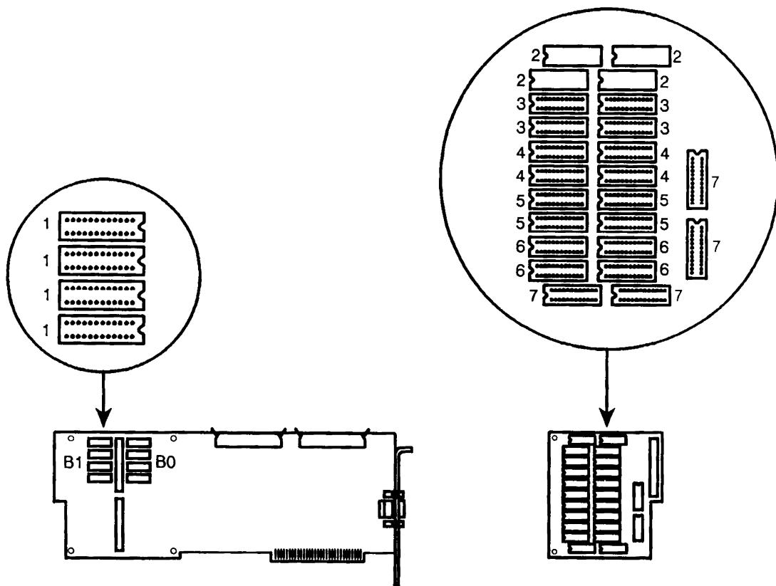
Il kit di espansione RAM HP 82303 fornisce un blocco di 512 kbyte di RAM (quattro CI). Potete installare fino a cinque di questi kit se possedete la scheda di espansione RAM HP 82305 (fate riferimento alla figura precedente per il posizionamento di ciascun blocco di RAM). Tuttavia, dovete osservare le seguenti regole per lavorare correttamente:
