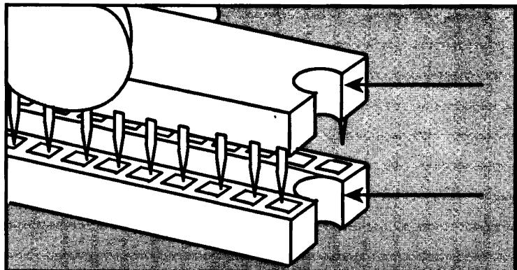
6. Allineate i piedini del CI con i fori dello zoccolo. Quando siete sicuri dell'allineamento, premete il CI fino a portarlo a contatto con lo zoccolo. Se qualche piedino non è inserito correttamente, rimuovete il CI e ripetete questo passo.
