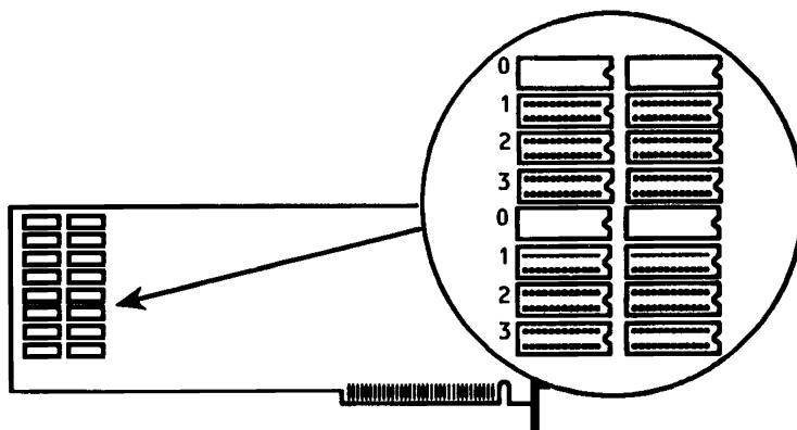
Il kit di espansione RAM HP 82303 fornisce un blocco da 512 kbyte di RAM (quattro CI). Potete installare fino a tre di questi kit sul controller grafico. La procedura per inserire i CI RAM nel controller grafico è essenzialmente la stessa del processore di linguaggio HP 82321, tranne che tutti i CI sono inserite sulla scheda stessa del controller. Non è necessaria la scheda di espansione RAM. Inoltre non esiste il commutatore di configurazione sul controller grafico (si auto-configura).
