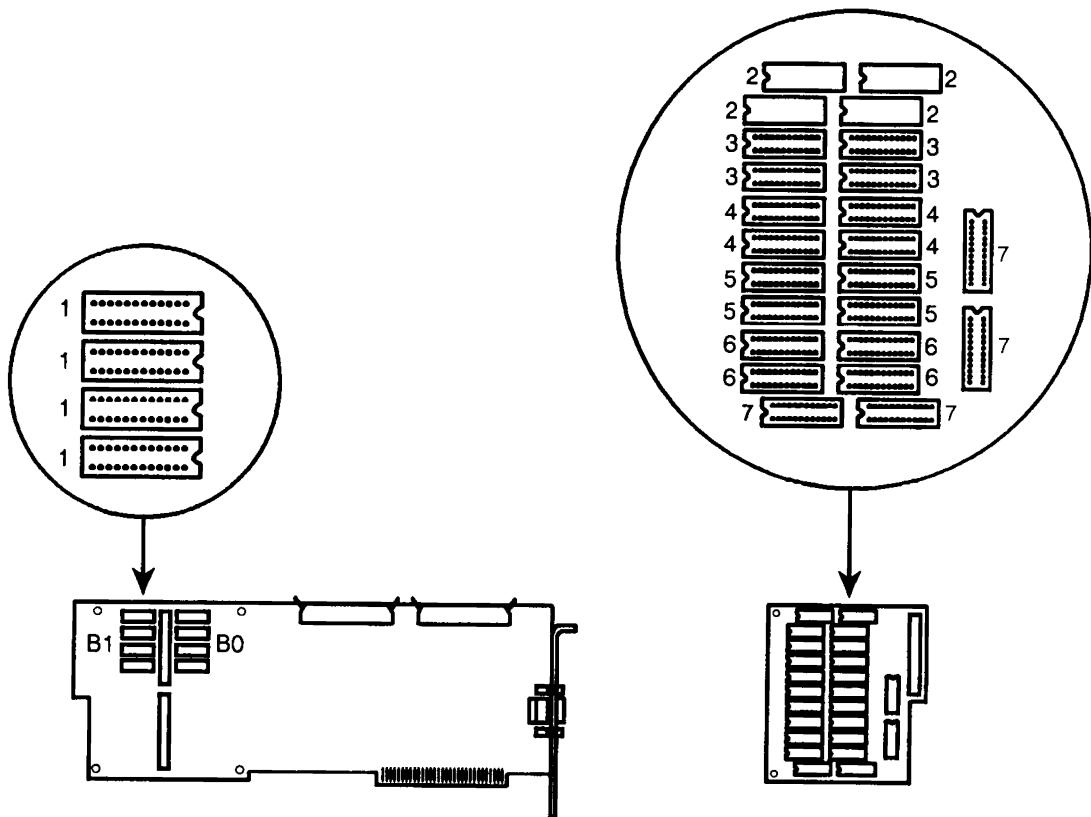
El Paquete de Ampliación de RAM HP 82303 le proporciona un bloque de 512 KB (cuatro CI) de RAM. Ud. puede instalar hasta un máximo de cinco de estos paquetes de RAM en la tarjeta de ampliación HP 82305 (Consulte la ilustración precedente para aprender la ubicación de cada bloque de RAM.) Sin embargo, tenga presente que debe ceñirse a las siguientes normas para que la memoria ampliada funcione correctamente:
