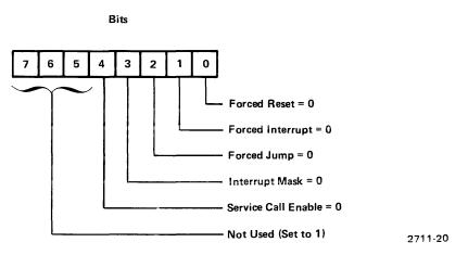
Fig. 6-1. Command Byte Format.
