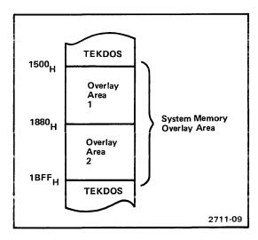
Fig. 1-8. System Memory Overlay Area.
