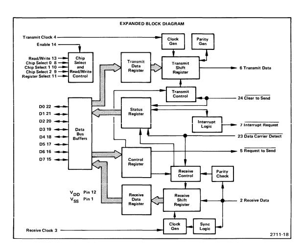
Fig. 5-2. ACIA Block Diagram.
