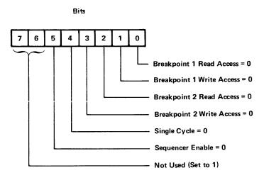
Fig. 6-2. Debug Control Byte Format.
