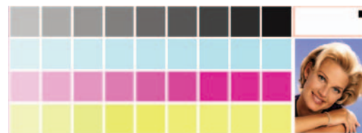
Impressão de diagnóstico usada para determinar a resistência à luz dos papéis fotográficos.
