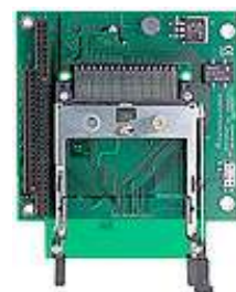
Ein PCMCIA-IDE-Adapter ACHTUNG: Der Amiga hat einen 2,5", die meisten Adapter 3,5"-Anschlüsse
