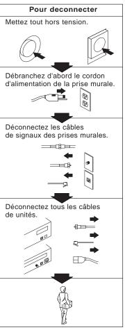
\*Le cordon d'alimentation doit être branché sur un socle de prise de courant correctement mis à la terre.
