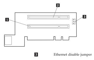
PCI slot 1PCI slot 2
