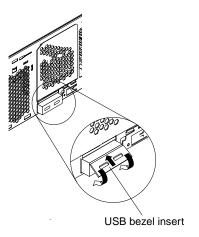
Figure 13. Installing the USB bezel insert
