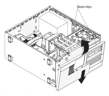
Figure 12. Installing the new bezel
