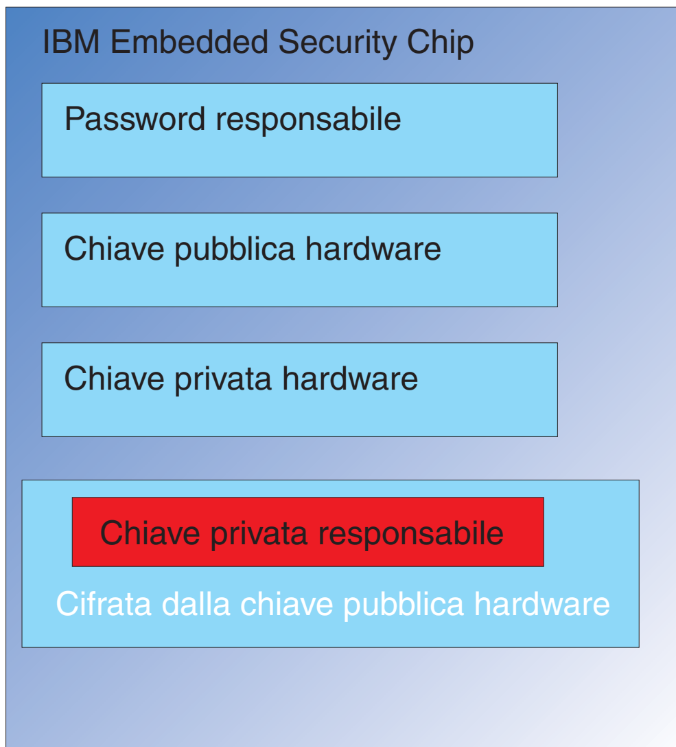
Figura 4. La chiave privata del responsabile, cifrata dalla chiave hardware pubblica, viene caricata nel chip di Embedded Security.
